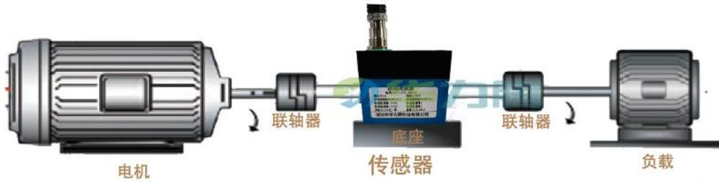
电机轴带动传感器和负载同轴转动，负载提供阻力。
